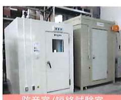
防音室/短絡試験室
