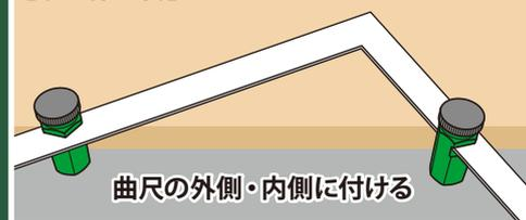
取り付け例のように、曲尺のどちら側に取り付けても構いません。外れたりしないように取り付けてください。
