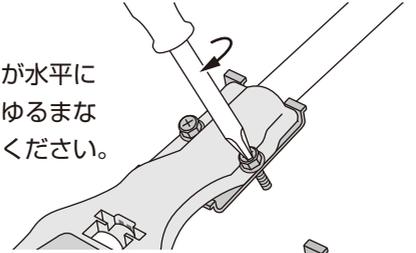
固定金具の向きによって、固定金具の端から穴までの長さが異なります。草刈チップソーガードの穴位置と固定金具の穴位置がピッタリ合う向きで固定金具を取り付けてください。
