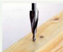
①テーパー錐で節の直径に合 わせて削る。
