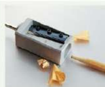
②節穴より少し太い枝を木栓 削りで削る。
