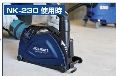
※最大風量4.5m<sup>3</sup>/minの集塵機に接続し、コンクリート板を切断した場合。(当社調べ)
