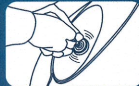
3 クリーニングする面に適度な圧力をかけながら磨きます。
