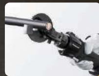
最大IV線325スケア ※イメージはCV線200スケア
