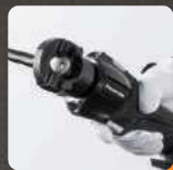
圧着端子、スリーブ60スケアまでを圧着可能
