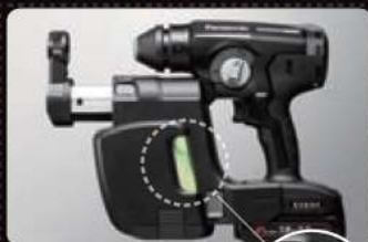
透明ダストケースで ゴミの量を一目で確認。 3分アンカー約20穴、集じん可能 ※穴あけ深さ40mmの場合
