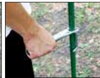
引き抜く場合 〈支柱の外側から取り付ける〉
